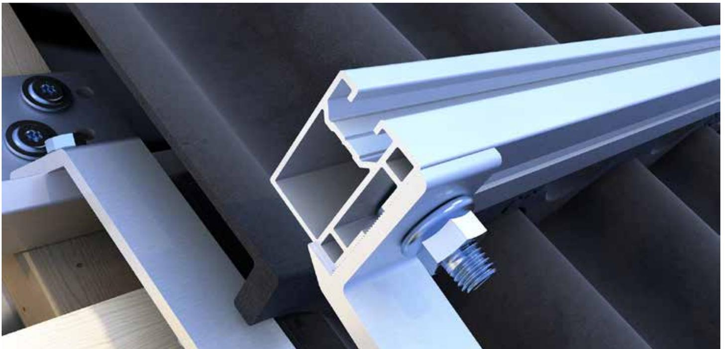
Montageprofil Steildach SLIM an Dachhaken FLEX SLIM mittels Hammerkopfschraube und Sperrzahnmutter befestigt.
