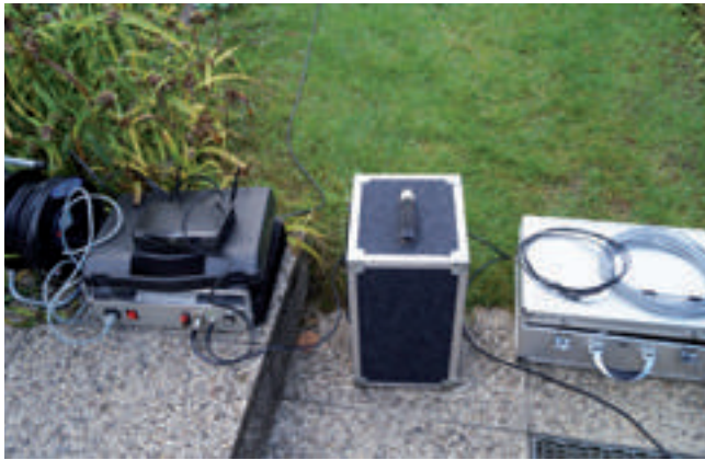
Künstlich erzeugter Straßenlärm für Messung
